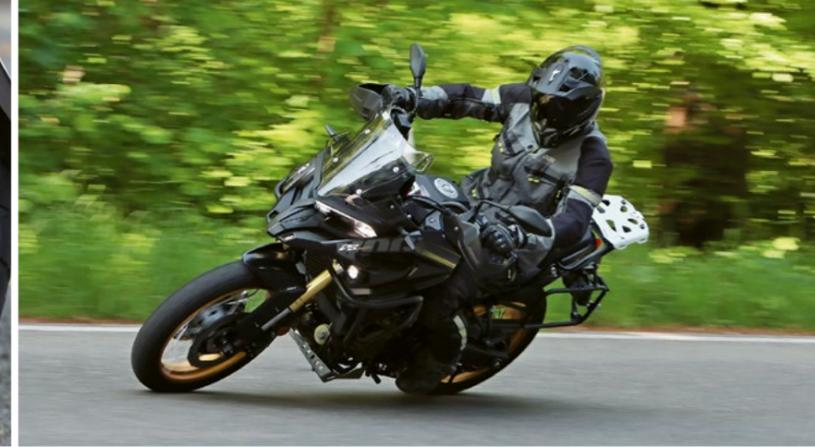
Eloxierte Kreuzspeichenräder (19-/17-Zoll) mit schlauchlos montierter Metzeler Tourance Bereifung, Wave-Bremsscheiben (298 mm) und Nissin Zweikolben-Schwimmsätteln. Die Voge 625 DSX hat mit Sturzbügeln, Nebelscheinwerfern und ihrer schnittigen Front einen starken Auftritt und fährt sich im Kurvenrevier unaufgeregt.
